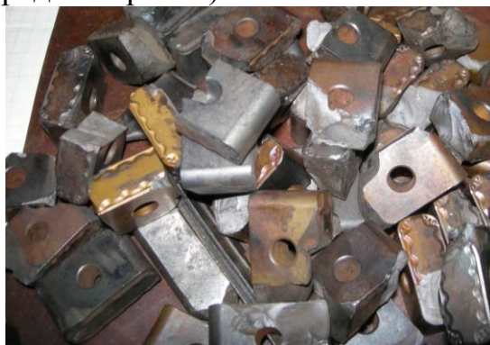
Рисунок 7. Списані твердосплавні пластини для важких верстатів, що досягли технологічного критерію відмови
