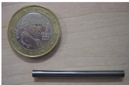
Циліндричний зразок діаметром 3.16мм для випробувань в умовах трьохточкового згину
