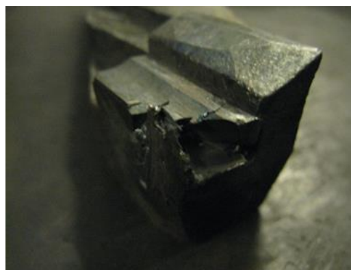
Рисунок 8 Руйнування змінної фрезерної пластини R390-180G12M-PM (а) та напайної різальної пластини з T5K10 (б)
