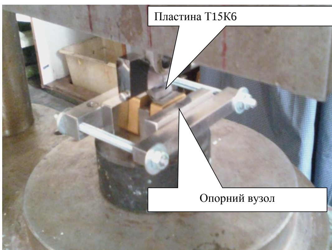
Рисунок 13 Тестування на згин змінної різальної пластини з T15K6 на устаткуванні ZD-40
