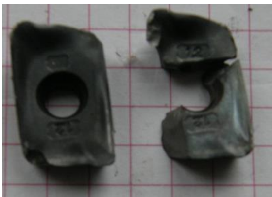
Рисунок 8 Руйнування змінної фрезерної пластини R390-180G12M-PM (а) та напайної різальної пластини з T5K10 (б)
